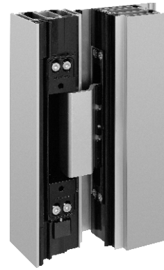
Verdeckt liegendes Türband, dreidimensional einstellbar, max. Öffnungswinkel 100°,
